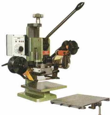
Slika 178. Slika stroja za otiskivanje folije
