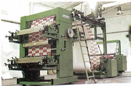
Slika 117. Fleksografski tiskarski stroj s prikazom tiskovne forme za fleksotisak
