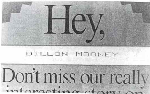
Slika 128. Ispis adrese na novinama ink-jet tiskom
