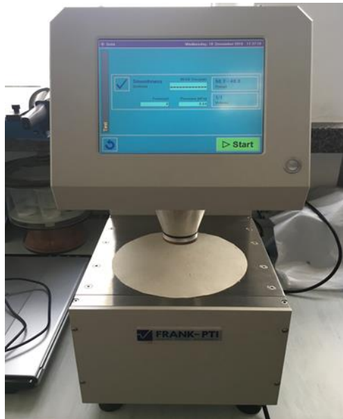
Slika 13. Uređaj za mjerenje glatкости papira PTI Austria GmbH PTA line BEKK tester
