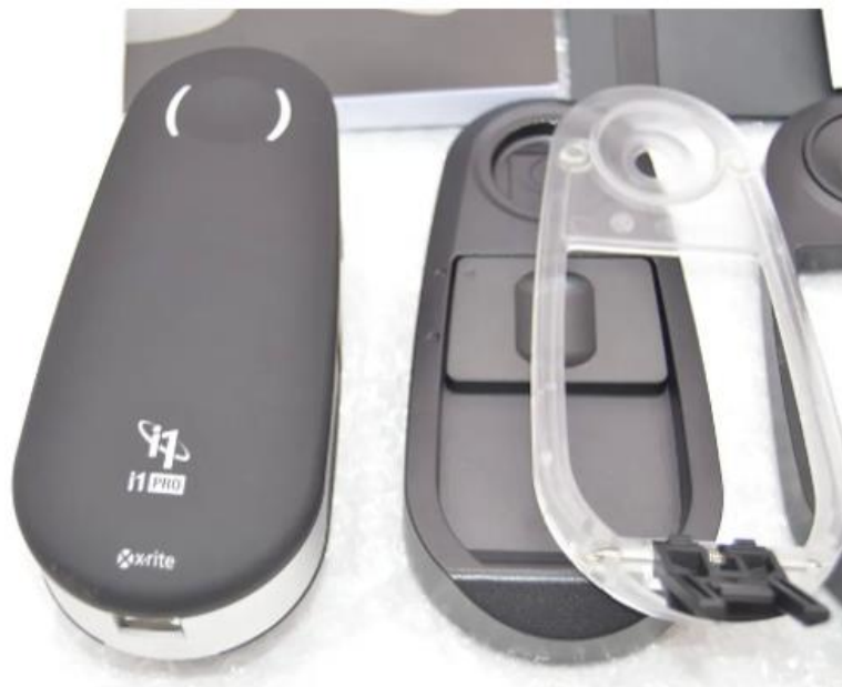
Slika 23 . Spektrometar X-Rite i1Publish Pro 2
